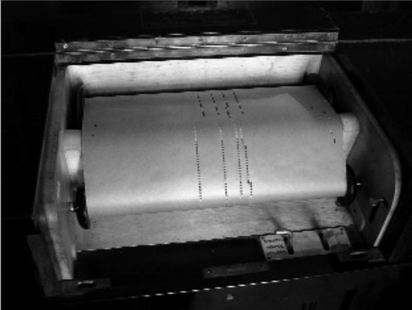
(1910). Эти аппараты имели разные модификации. Они выпускались и в отдельных корпусах, приставляемых к клавиатуре фортепиано, и в общем корпусе с роялем или пианино. Перфолента, намотанная на деревянную катушку, называлась роликом.
